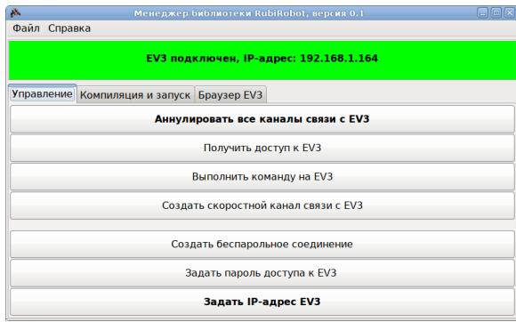
Внешний вид менеджера с подключенным к компьютеру EV3 можно увидеть на изображении слева. Элемент "**Аннулировать все каналы связи с EV3**" вкладки "Управление" может быть крайне полезен при зависании скоростного канала связи с роботом. К сожалению, данный факт невозможно определить в автоматическом режиме, поэтому при резком замедлении коммуникаций с EV3 рекомендуется нажать на эту кнопку.
