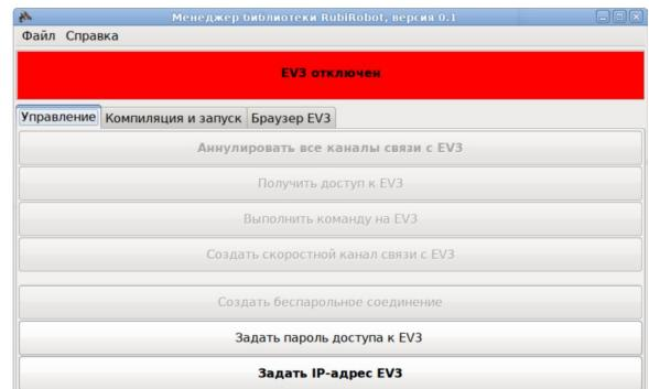
корректный IP-адрес с помощью кнопки "Задать IP-адрес EV3" вкладки "Управление". Также, если доступно несколько роботов одновременно, такой подход позволяет выбрать одного из них.
