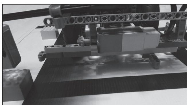
Рис. 8. Позиционирование робота-ткача в зоне сбора кубиков
