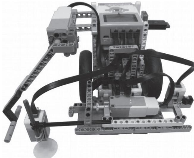
Рис. 7. Робот-ткач: ряд ковра собран и зафиксирован
